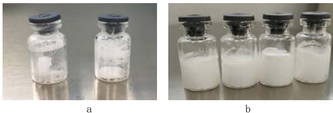
图2: a: 冻干未使用封口膜; b: 冻干过程使用封口膜
