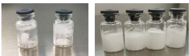
图2. a: 冻干未使用封口膜; b: 冻干过程使用封口膜
